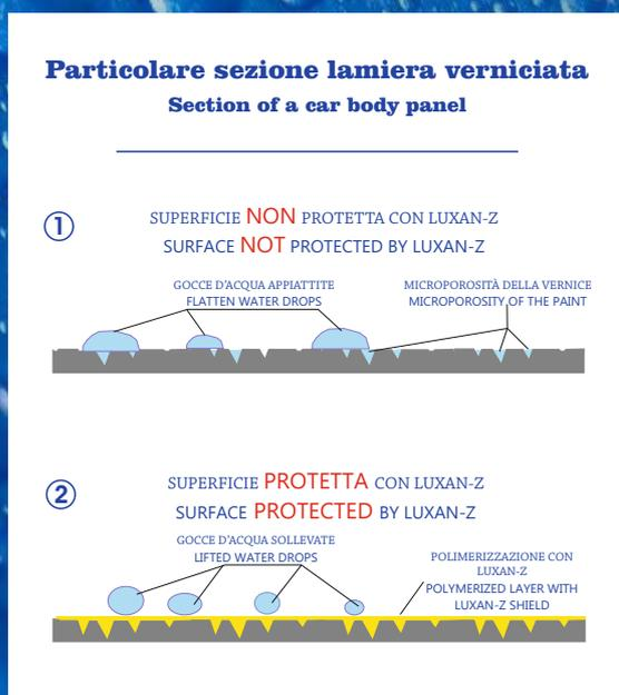
Nel primo schema, la goccia d'acqua è difficilmente spostabile con il soffio d'aria, nella seconda invece la goccia è molto più sollevata dalla superficie offrendo un punto di contatto con la carrozzeria molto ristretto, di conseguenza offre una minima resistenza allo scorrimento. Quest'azione è dovuta all'elevato grado di protezione e gloss che la nano-tecnologia del polimero LUXAN-Z è in grado di fornire (contenuto in tutte le cere e polish ALTUR).
